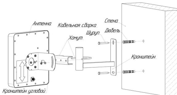
Рисунок 2 – Монтаж антенны
