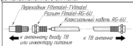
Схема 1 – Сборка антенного кабеля
