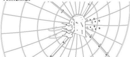
Шаг 4. Закрепите крепежную скобу и хомут для крепления антенны на мачте.
