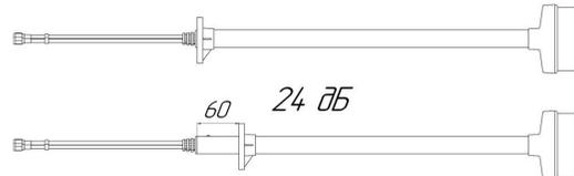
Крепежное основание облучателя 24 дБ необходимо сдвинуть на 60 мм, как показано на чертеже. Ориентируйтесь по красным меткам на трубке облучателя для точного позиционирования крепежного основания.
