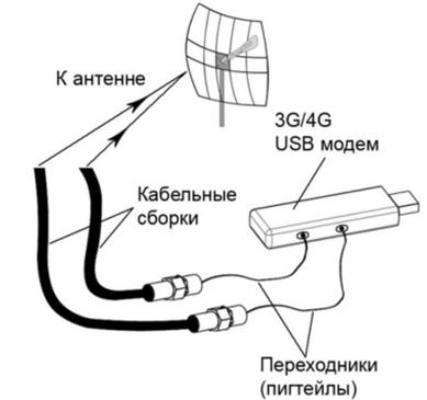
Пример подключения 3G/4G USB модема
